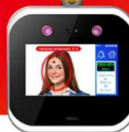
Quando il terminale rileva una temperatura della fronte sopra una prefissata soglia, viene generato un avviso acustico e viene inibito l'accesso.
