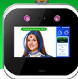
Il comando di apertura del tornello (o dell'elettroserratura) viene dato solo se la temperatura è normale.
